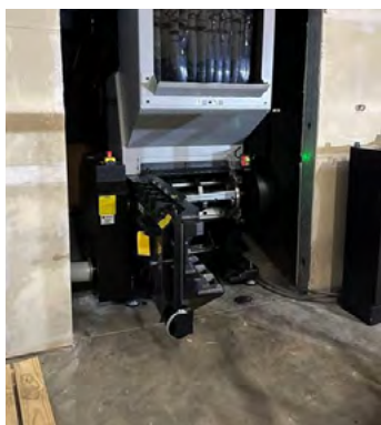
Plast kværn hos Gibo Inc. installeret i et nyetableret område i fabrikken.
