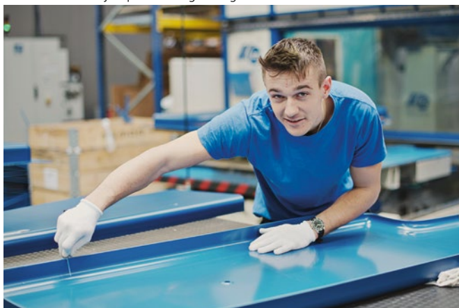
Andrezej Filipiak ved afgratning af vakuumformet emne.
