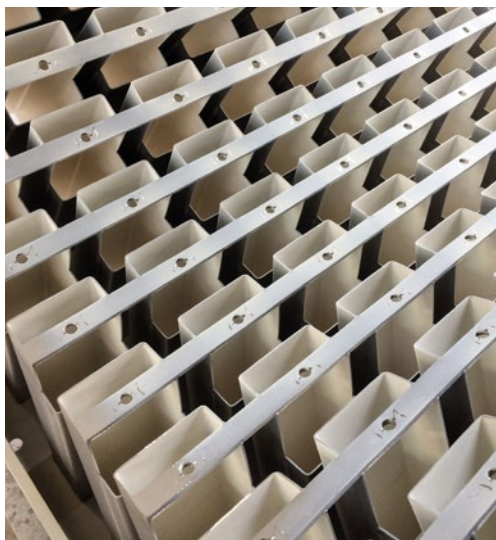
Produktionsudstyr til osteproduktion belagt med Accolan W98
